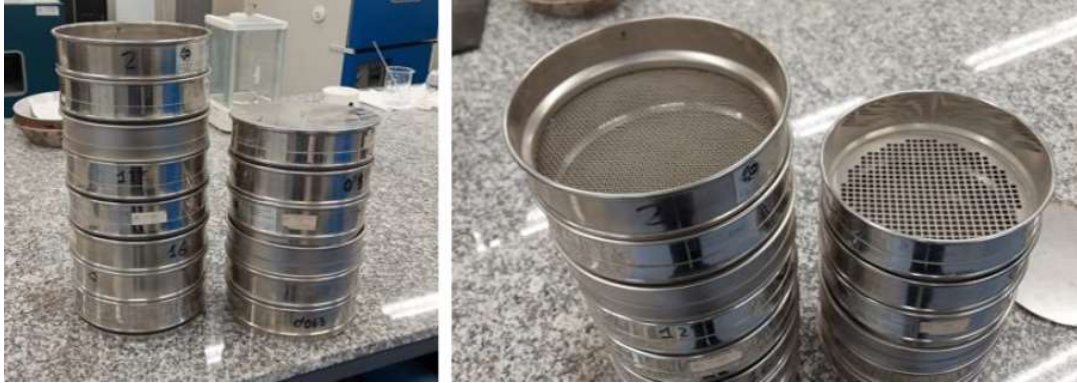
Tamices para obtención de granulometría en mezclas bituminosas s/Norma UNE-EN 12697-2
